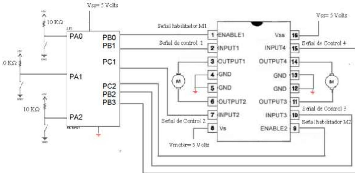
Figura 5.10 Circuito control de motores de CD
