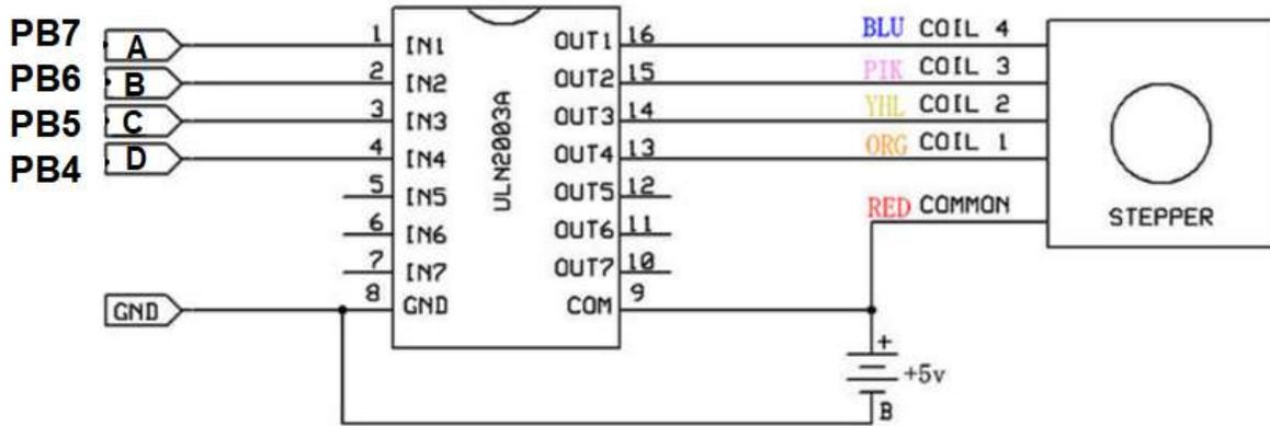
Figura 5.11 Conexión de motor a pasos
